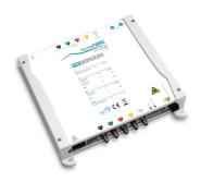
Trasmettitore ottico per la distribuzione fino a 4 satelliti su una singola fibra con tecnologia CWDM (Coarse Wavelenght Division Multiplexing). Soluzione innovativa che permette di trasmettere l'intera banda TV, comprensiva dei segnali radio, e una intera posizione orbitale su una singola fibra. 7dBm con laser FP SAT+TV+FM, lunghezza d'onda 1310nm. (dimensioni 230x230x50mm)
