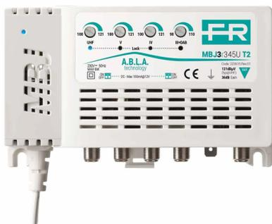
Centralino con 4 ingressi (III+DAB, IV, V, UHF) da interno autoalimentato con guadagno 20dB e livello di uscita fino a 115dB $\mu$ V in banda UHF, amplificazioni separate, regolazioni del livello (20dB) indipendenti per ogni ingresso e bassa figura di rumore. **Tecnologia T2** con filtro integrato per eliminare le interferenze 5G a 694MHz.
