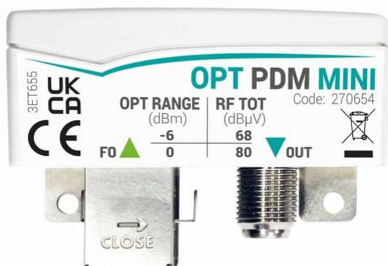
Ricevitore ottico passivo miniaturizzato con una uscita RF larga banda per la ricezione dei segnali di TV+SAT distribuiti su una singola fibra. Range ottico di ingresso compreso tra 0 e -6dBm; finestra ottica di funzionamento 1270-1610nm. (dimensioni 47x33x15mm)
