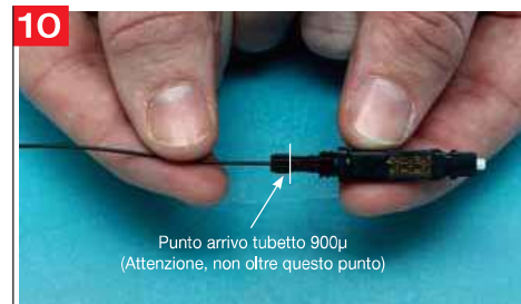
10 Avvicinare il rivestimento 900 \mu ed inserirlo nel connettore a battuta. Punto arrivo tubetto 900 \mu (Attenzione, non oltre questo punto)
