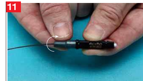
11 Avvitare il boot sul corpo connettore per bloccare la fibra.
