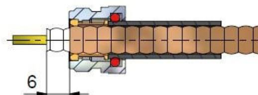
**5** Avvitare il corpo (pos.3) al serracavo (pos.1) utilizzando le due chiavi fisse, con una forza di serraggio pari a 20 N/m.
